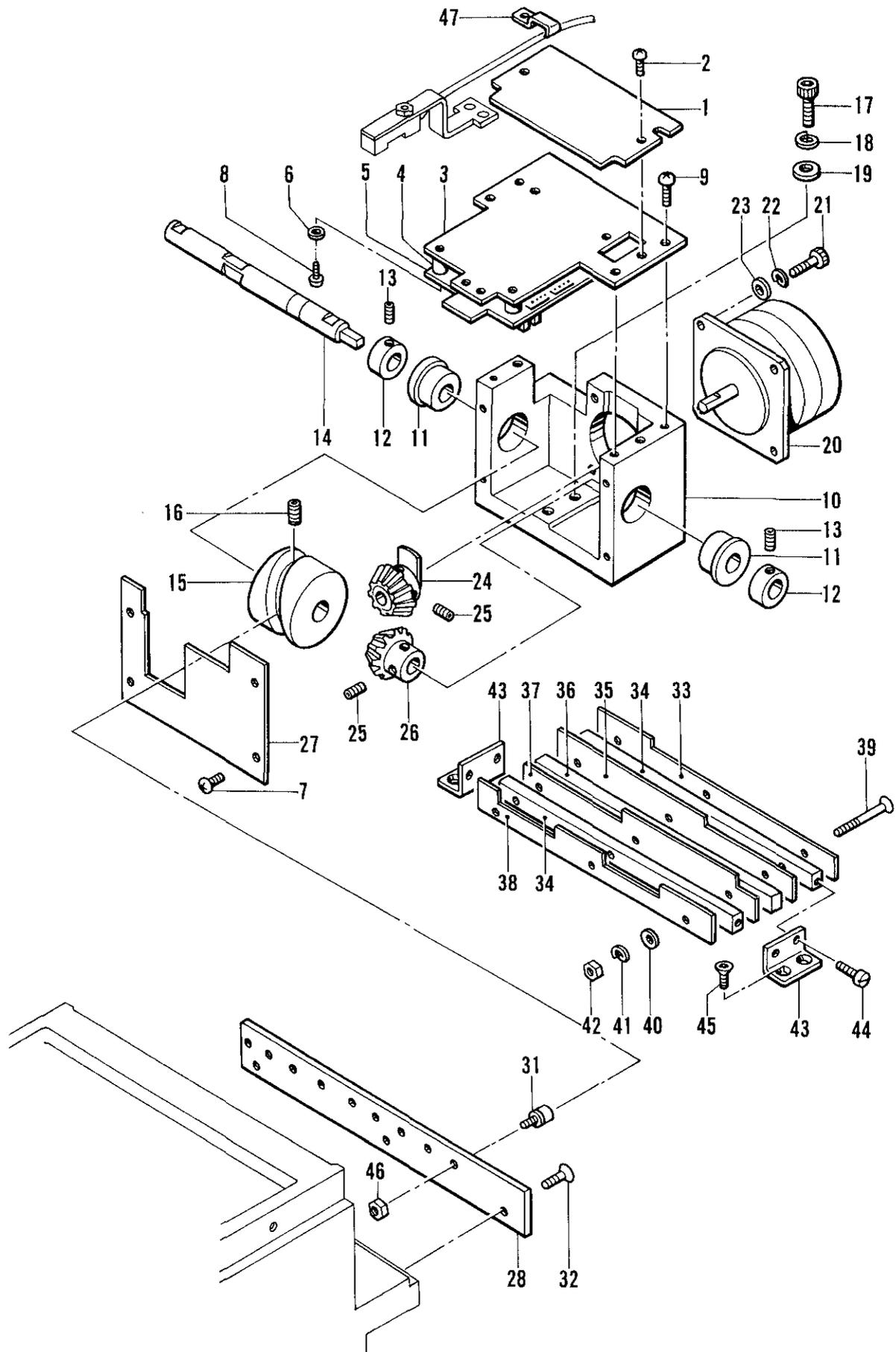
F. 針棒切替工操作関係/Needle bar flip-up mechanism/Nadelstangehochstellung/
