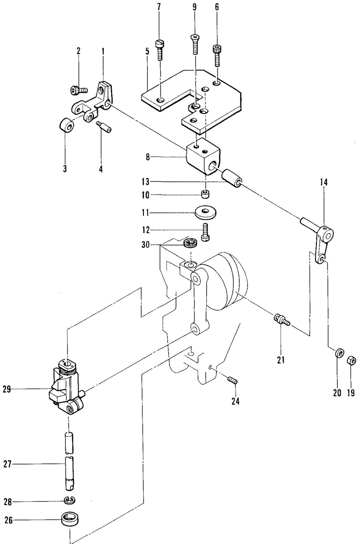
C. 針棒駆動関係/Needle bar and driving clutch mechanism/Nadelstange und antriebskupplung/Barre à aiguille et mécanisme d'embrayage d'entraînement/Barra de aguja y mecanismo de embrague de mando
