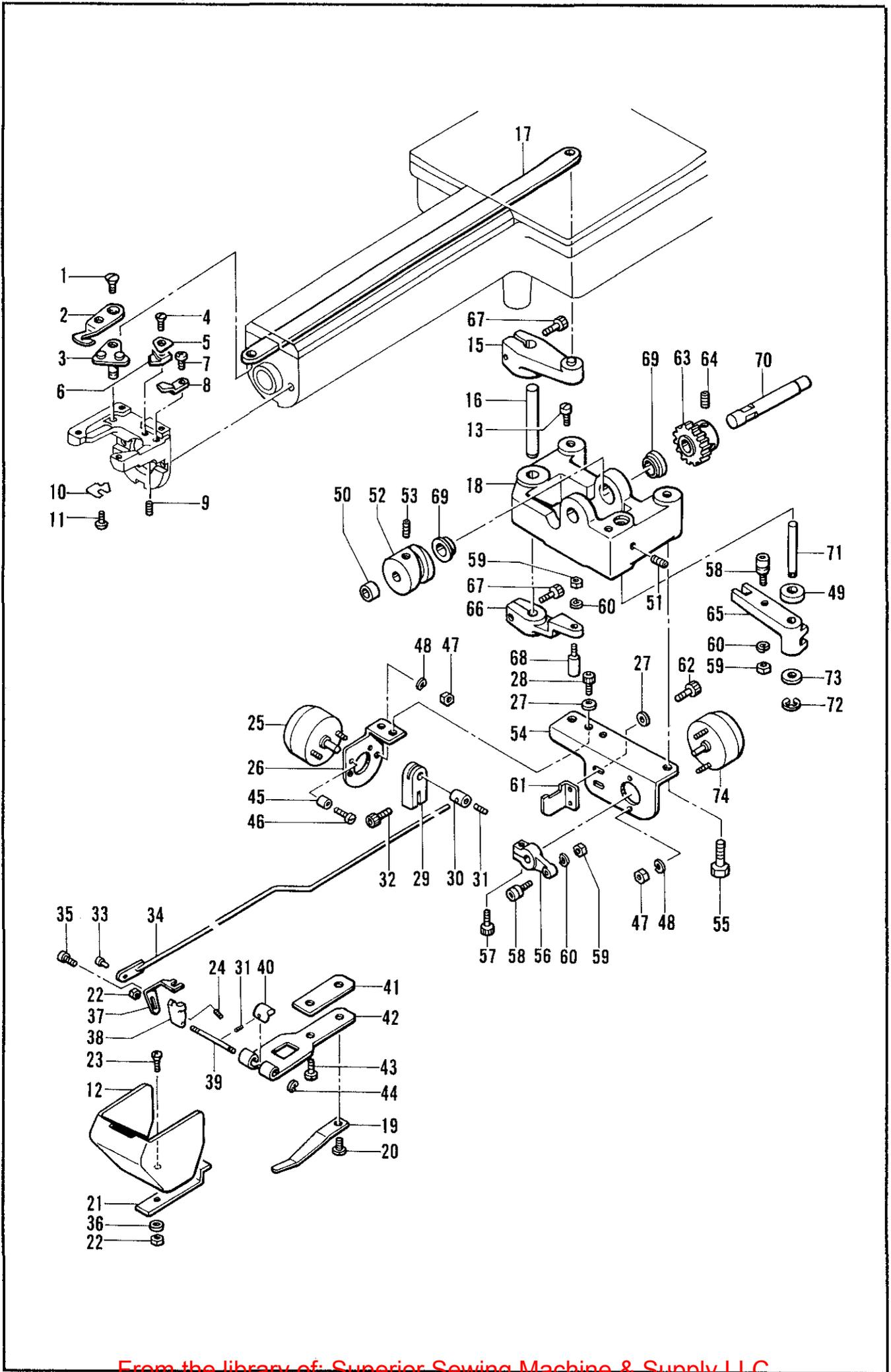
E. 糸切り関係/Thread trimmer mechanism/Fadenabschneidevorrichtung/
