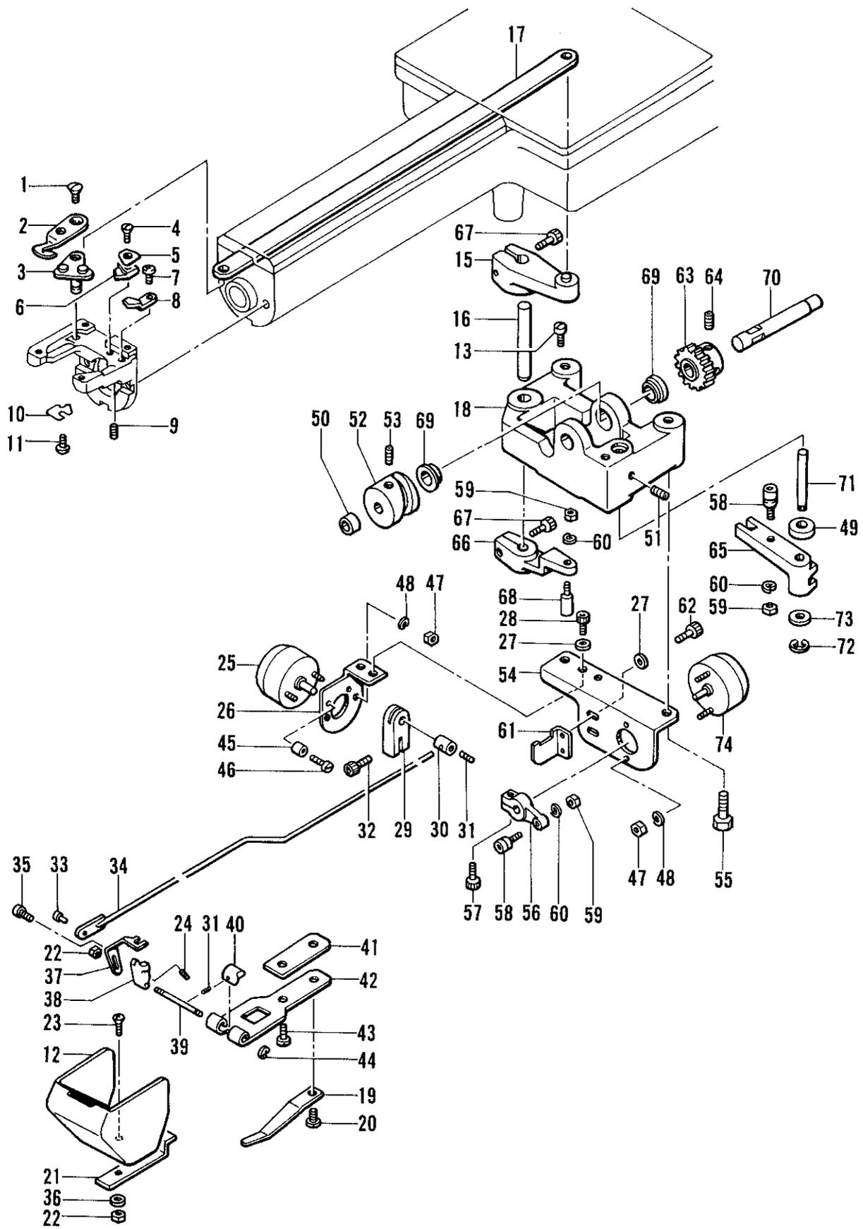
E. 糸切り関係/Thread trimmer mechanism/Fadenabschneidevorrichtung/
