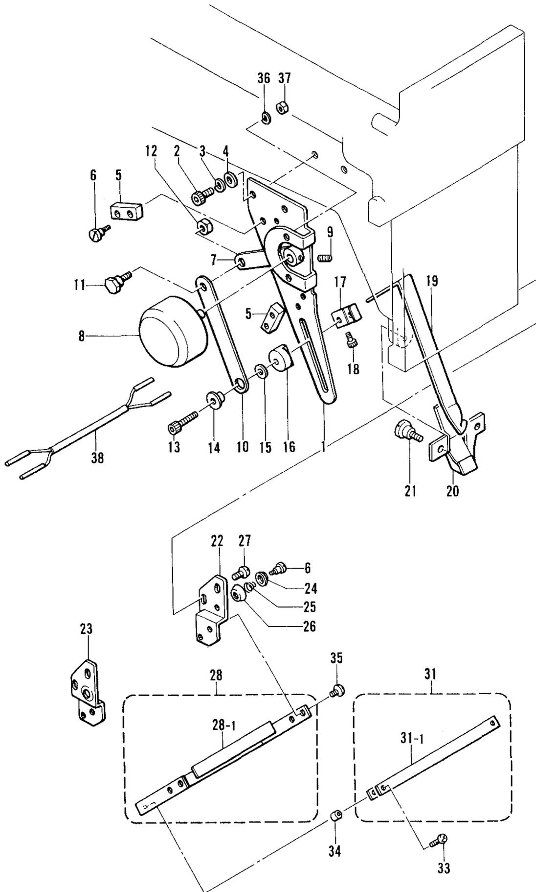
D. 糸払イ関係/Thread wiper mechanism/Fadenwischvorrichtung/
